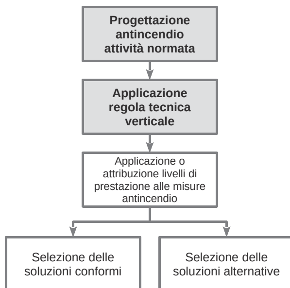
Illustrazione G 2.3: Progettazione antincendio delle attività normate
