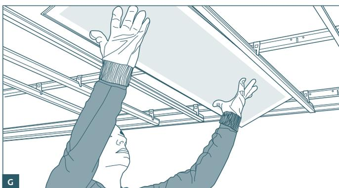
Durante l'installazione delle doghe Gyptone Xtensiv maneggiare il prodotto con guanti di cotone per non sporcarlo. Sollevare un lato della doga al di sopra della struttura. In questo modo c'è sufficiente spazio per sollevare l'altro lato e posizionarlo sul profilo secondario opposto. Tutti gli impianti devono essere terminati prima di iniziare la posa delle doghe.
