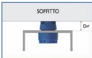
Conoscendo il carico da applicare a ogni singola sospensione si può stabilire la distanza tra l'accessorio e il manufatto. ( $D_M'$  = distanza di montaggio). Per avere la max prestazione smorzante è necessario che la forza di fissaggio della vite coincida con il carico applicato (effetto galleggiamento). Da esperienze dirette in opera si consiglia di applicare a ciascun elemento carichi compresi tra 21,6 e 26,2 kg.
